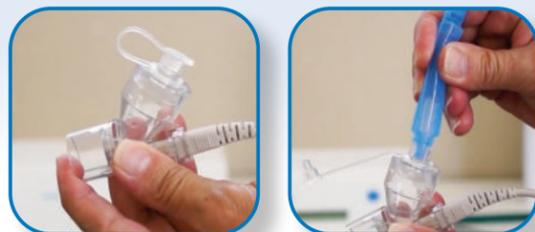
Si **NO** está utilizando humidificación, conecte la parte superior del humidificador con el tapón del humidificador e inserte el humidificador en la bota mirando hacia el extremo de la punta de la bota.
